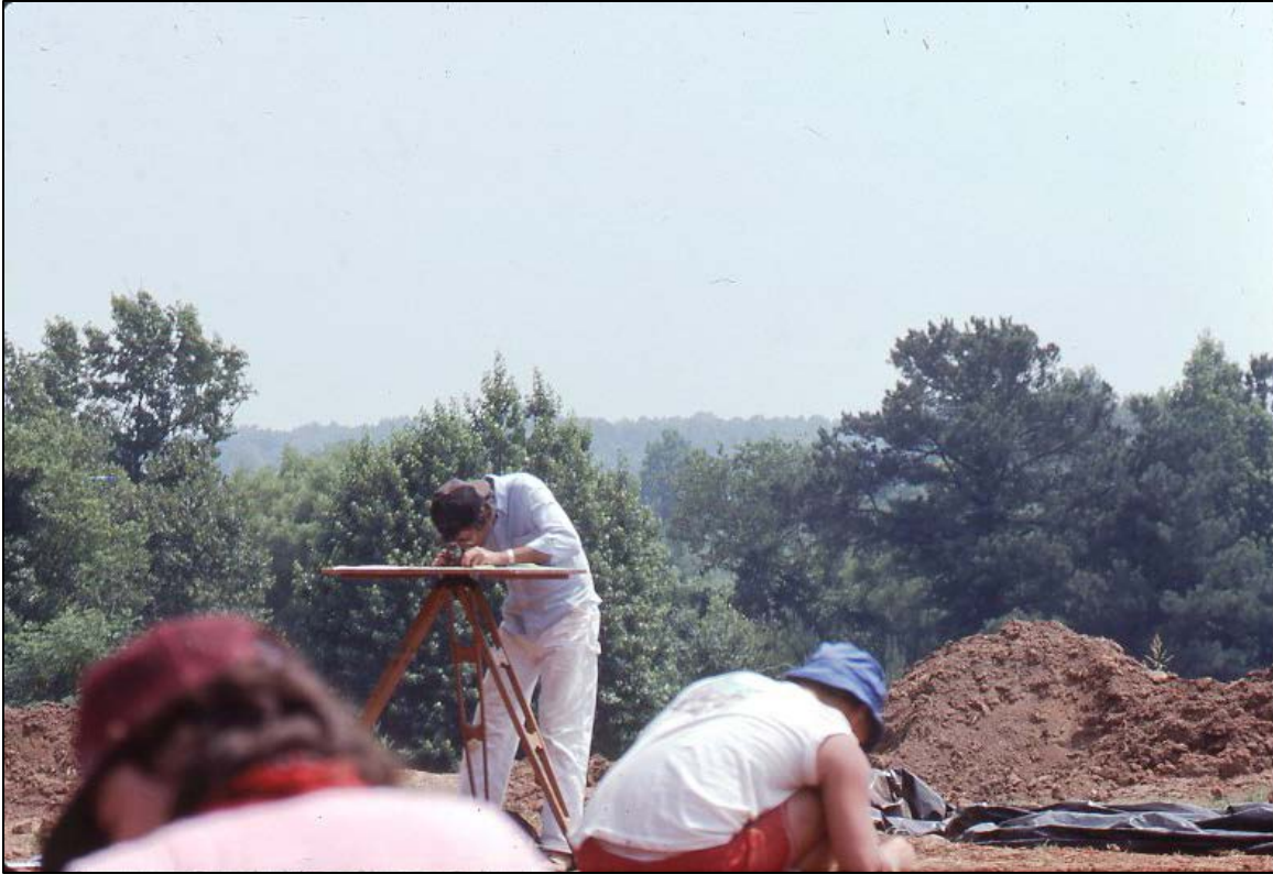
Figure 29. Hatch using the plane table and alidade.
